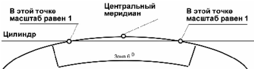
Рис. 17. Проекционные преобразования в проекции UTM
